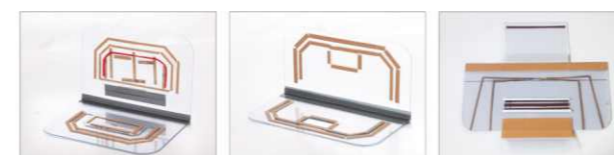
牛仔模板 Jeans Templates 适用于前袋口模板、前中拉链模板、开袋模板等等。
